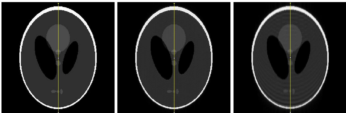
Figura 36. Imágenes obtenidas adquiriendo el 100% del espacio k , el 75% y el 60% respectivamente y rellenando con ceros los datos no adquiridos. Podemos apreciar la aparición sucesiva de ringing . La línea vertical representa el perfil elegido para representar gráficamente la aparición de ringing .
